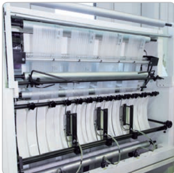
Slit seal device Gruppo taglia e salda
